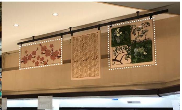
木材を下地に、印刷したテンタック「TN 003C」を貼り装飾。(点線部分) 高い印刷再現性で木材へのプリント表現が可能です。
