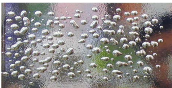
▲ アウトガスにより、気泡ができたアルミ蒸着のミラーシート。
